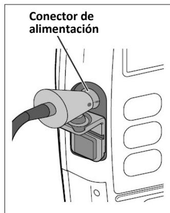
**PRECAUCIÓN:** No empujar el conector hasta que haga tope puede tener como resultado una conexión intermitente y el conector puede desplazarse, lo que provocaría la pérdida de energía.
